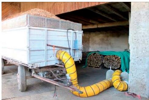
47. attēls. Konteinerim pievienotas gaisa apkures caurules šķeldu kaltēšanai biogāzes rūpnīcā Minhenē, Vācija (Avots: D. Rutz).
