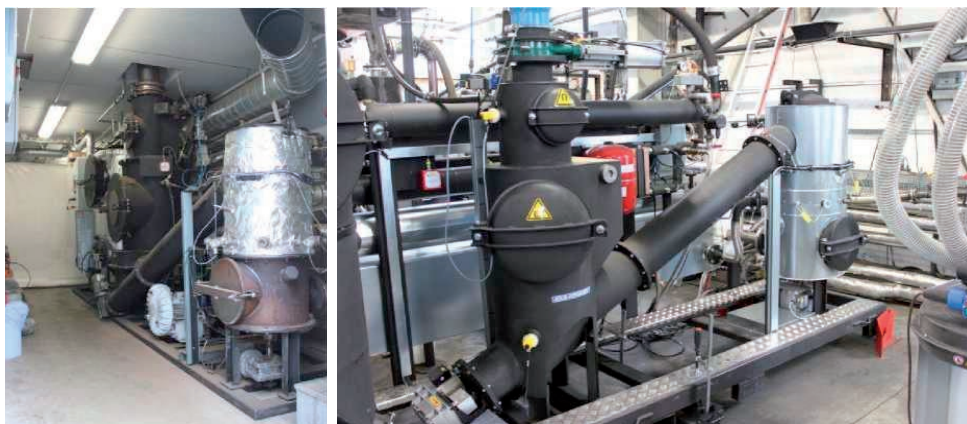
59. attēls. Mazizmēra gazifikatori konteinerī (pa kreisi) un ražošanas laikā (pa labi) „SpannerRE 2 ” rūpnīcā (Avots: D. Rutz).
