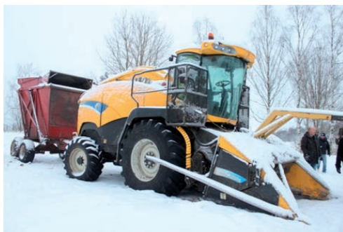
38. attēls. New Holland pašgājējmašina ar piekabi šķeldai (Avots: D. Rutz).
