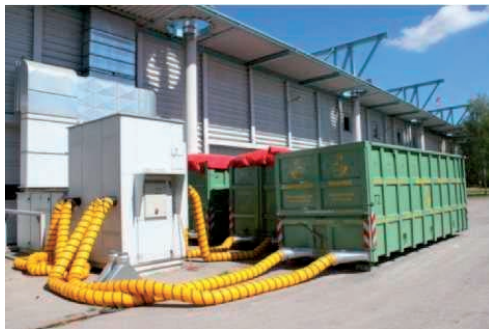
47. attēls. Konteinerim pievienotas gaisa apkures caurules šķeldu kaltēšanai biogāzes rūpnīcā Minhenē, Vācija (Avots: D. Rutz).
