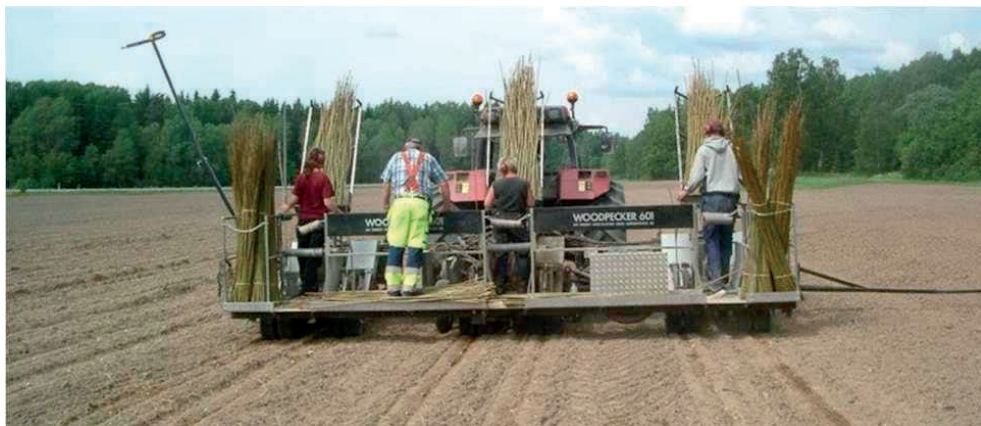
29. attēls. Kārķu SRC stādmašīna, kas veic trīs dubultrindu apstādīšanu vienlaicīgi; darbam nepieciešami četri cilvēki un autovadītājs (Avots: N-E. Nordh).
