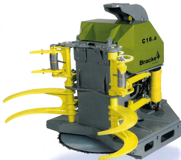
Akumulējošā griezējgalva Bracke C16B (Avots: www.brackeforest.com ).
