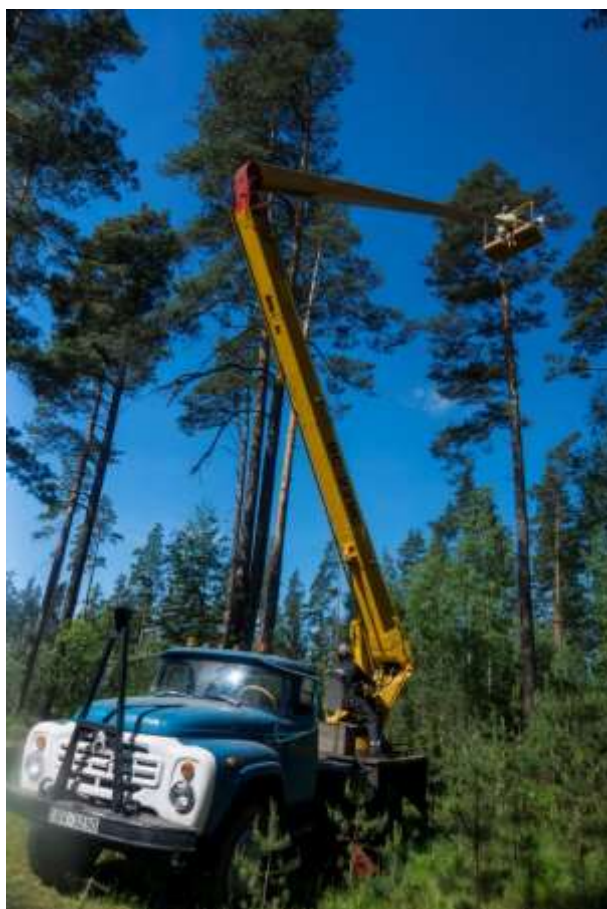
3.5.4. attēls. Delta slazdu izvietošana vainagā izmantojot auto pacēlāju (A. Šmita foto)
