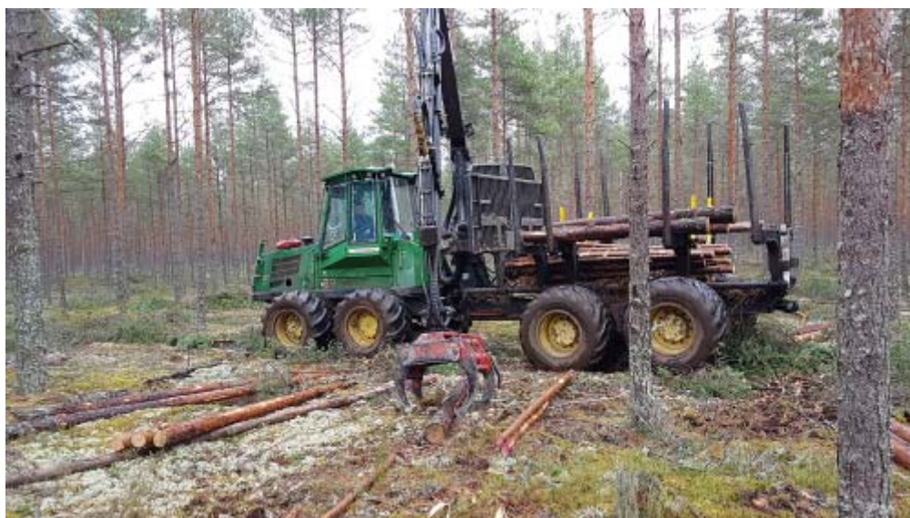
Att. 24: John Deere 1110D ECO III piedevjtraktors ar greiferi, kas aprīkots ar papildus satveršanas mehānismu.
