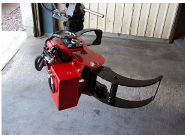
Att. 20: “Tilta” kausa (greifers ar pacelšanas funkciju) konstrukcijas un pielietošanas piemērs 9 .
