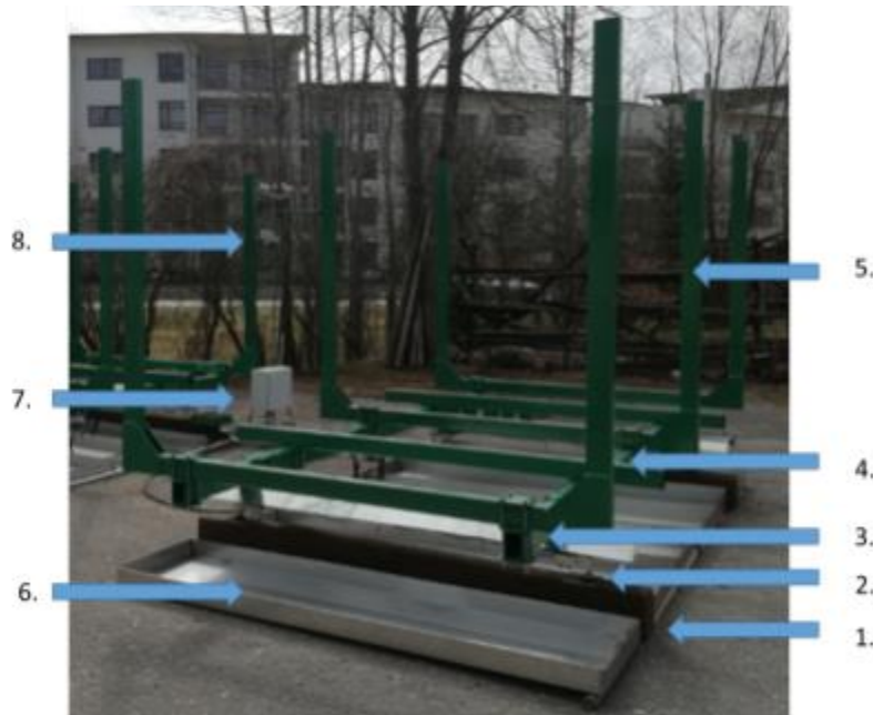
Att. 2: Iekārta mitruma satura izmaiņu, biogēno elementu izskalošanās un biomasas mineralizācijas novērtēšanai.
