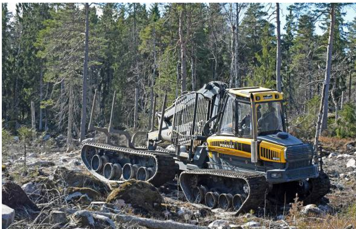
OnTrack pievedējtraktora pārvietošanās spēju pārbaude akmeņainā apvidū Skogforsk izmēģinājumu poligonā.
