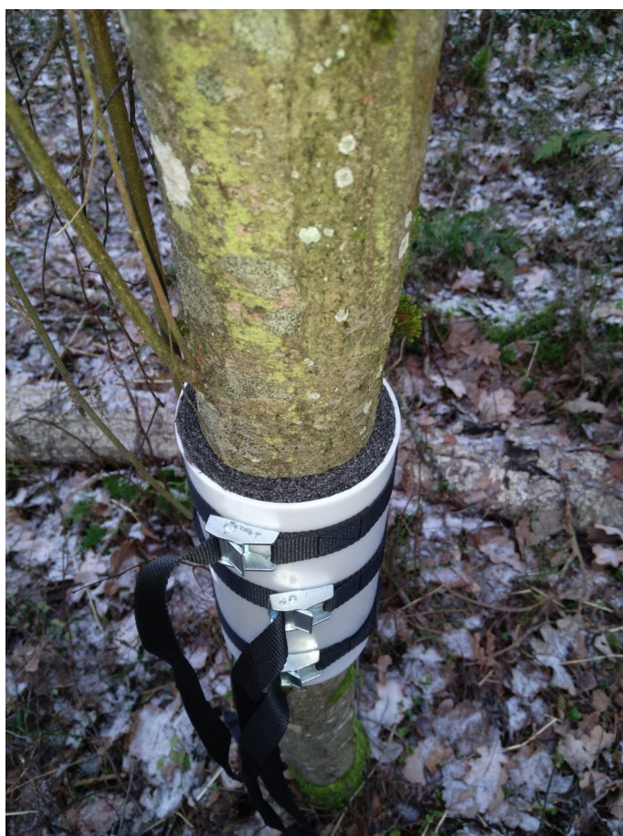
Att. 2. Uzstādīta gāzu apmaiņas mērīšanas kamera.
