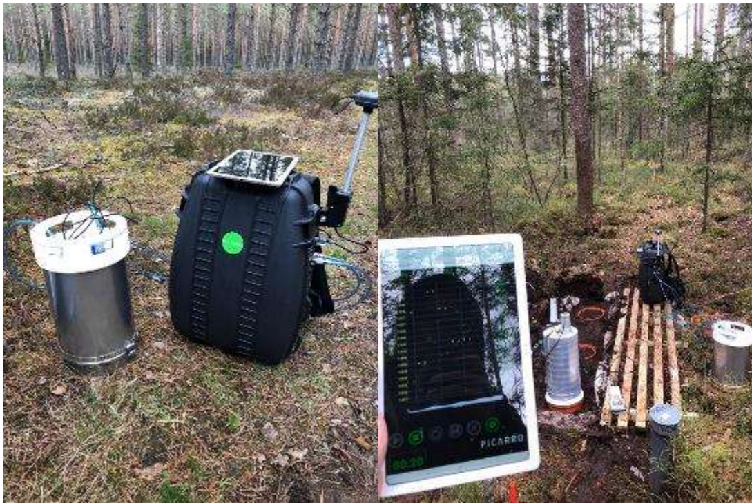
5.5. attēls. Picarro CO 2 , CH 4 gāzu analizators ar tumšo kambari
