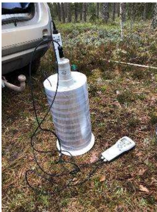
5.4. attēls. Vaisala CO 2 gāzu analizators ar tumšo kambari
