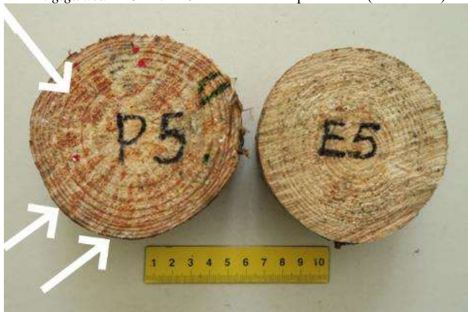
4.11. att. P. gigantea attīstība (oranžais krāsojums – norādīts ar bultu) priedes (P) un egles (E) ripās rietumu virzienā 5 m attālumā no augļķermeņa
