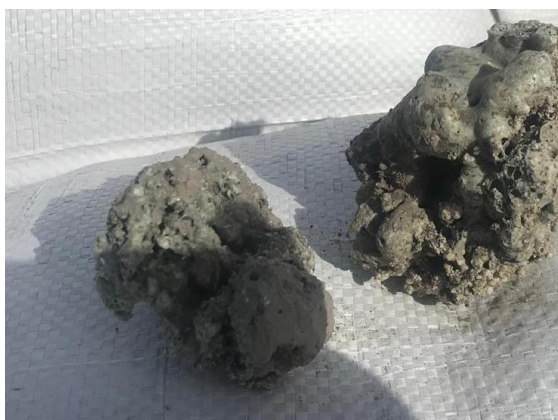
6. att. Sakusušās smiltis, kas izveidojušās kurtuvē
