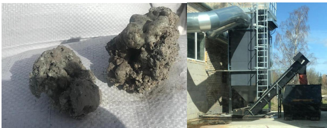
7.3. att. Šķeldu katlumājas pelnu paraugu iegūšana: A - Sakusušās smiltis, kas izveidojušās kurtuvē; B - Sietā potenciālā atrašanās vieta pie pelnu uzkrāšanas
