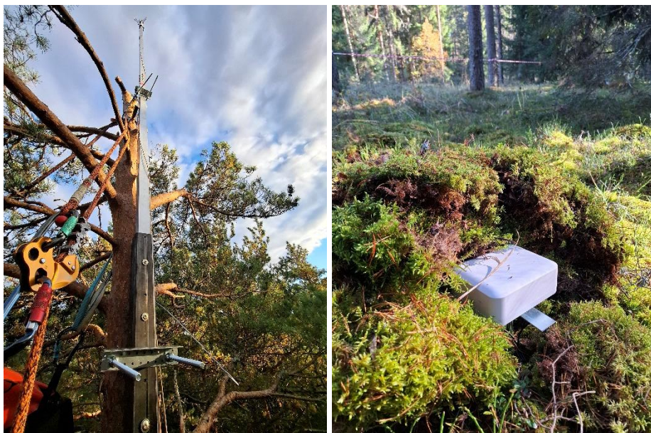
Ultraskaņas anemometrs koka galotnē un barometrs zem vēja mērīšanas punkta
