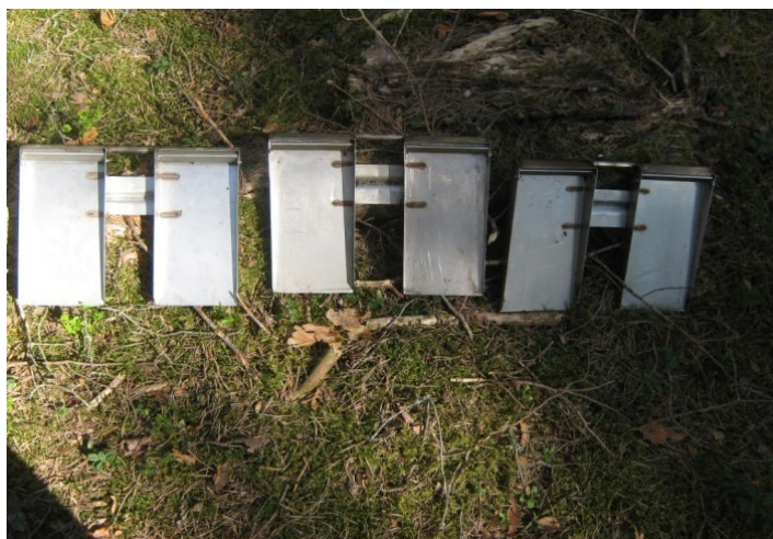
Att. 8: Nulles spiediena lizimetri pirms uzstādīšanas 10 .
