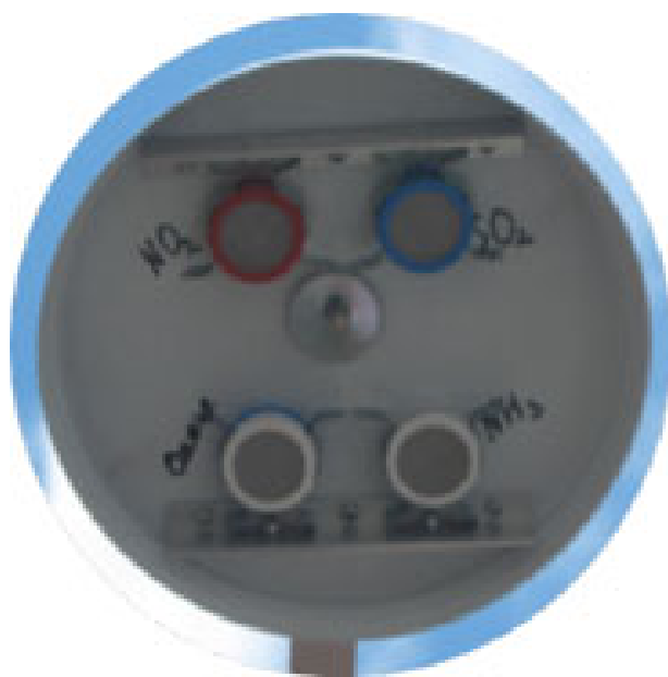
Att. 5: Membrānas tipa pasīvie gaisa paraugu savācēji 7 .
