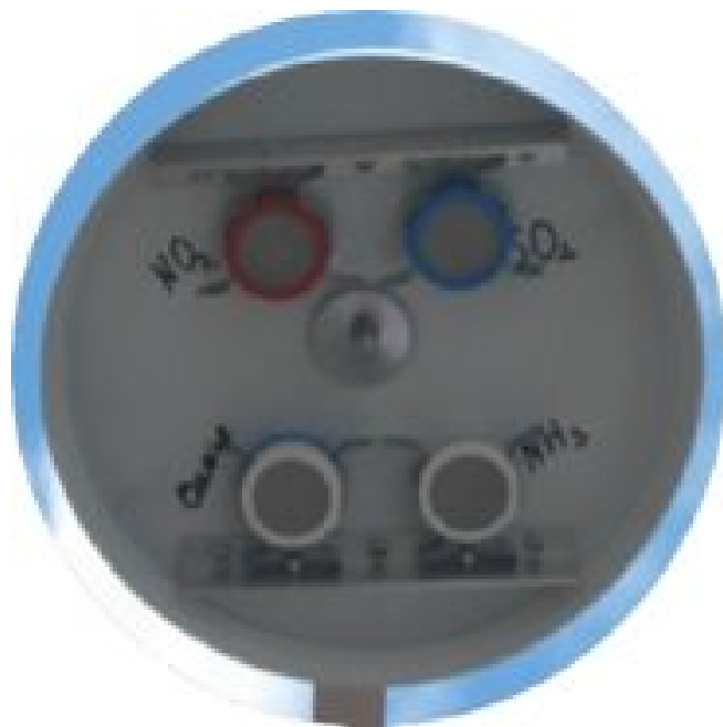
Att. 5: Membrānas tipa pasīvie gaisa paraugu savācēji 6 .
