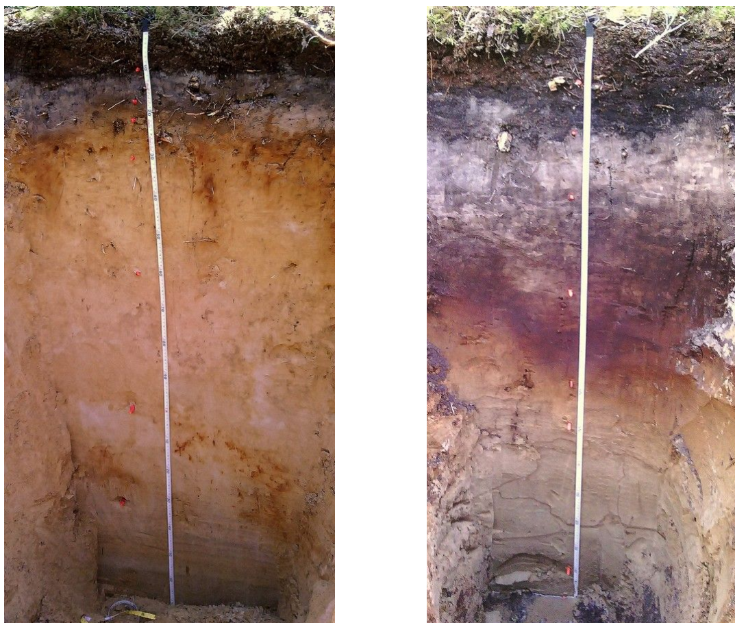
Att. 3: Augsnes profili Valgundes parauglaukumā, pa kreisi reljefa paaugstinājumā, pa labi reljefa pazeminājumā 3 .
