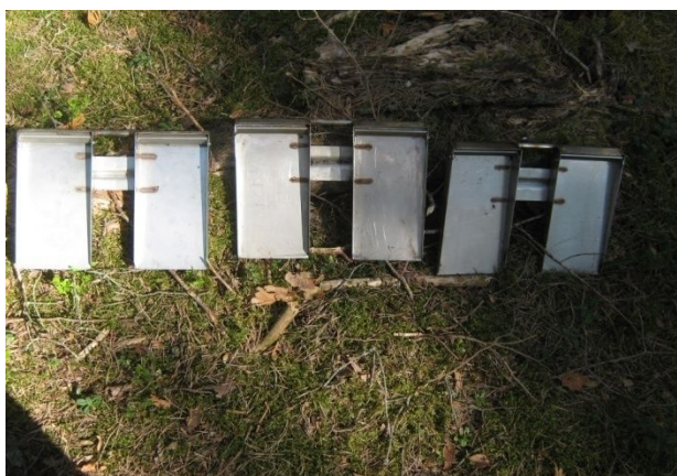
Att. 8: Nulles spiediena lizimetri pirms uzstādīšanas 9 .
