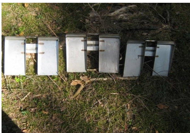
Att. 8: Nulles spiediena lizimetri pirms uzstādīšanas 9 .
