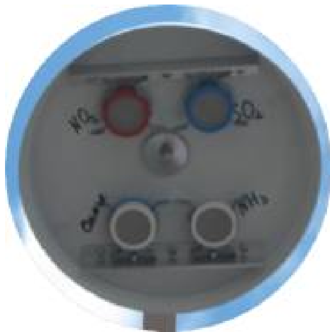
Att. 5: Membrānas tipa pasīvie gaisa paraugu savācēji 6 .
