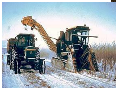
Att. 12 Dažādi pašgaitas kārķu pļaušanai un šķeldošanai izmantojami kombaini
