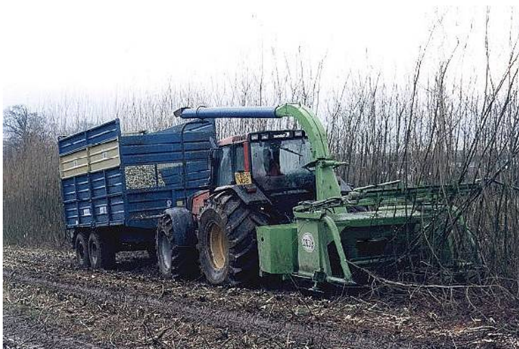
Att. 13 Pļaušanas un šķeldošanas mašīna uz traktora bāzes
