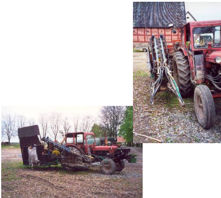
Att. 11 Pašdarināts agregāts dzinumu griešanai kārķu stādaudzētavā (Zviedrija)
