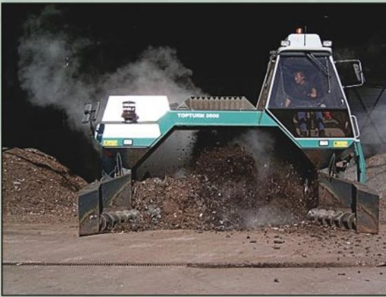
Saskaņā ar MK noteikumiem par noteikudeju dūnu un to kompostu izmantošanu, monitoringu un kontroli kompostēšana ir process, kura laikā vismaz trīs diennaktis temperatūrai kaudzes iekšienē, 50 cm no kaudzes virskārtas, jābūt ne mazākai par 60°C.
