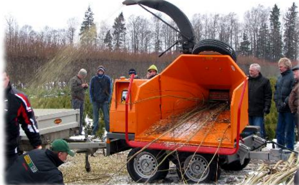
20. Attēls: Kārklu šķeldošana ar mobilajiem šķeldotājiem.
