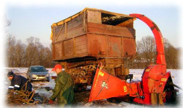
20. Attēls: Kārklu šķeldošana ar mobilajiem šķeldotājiem.
