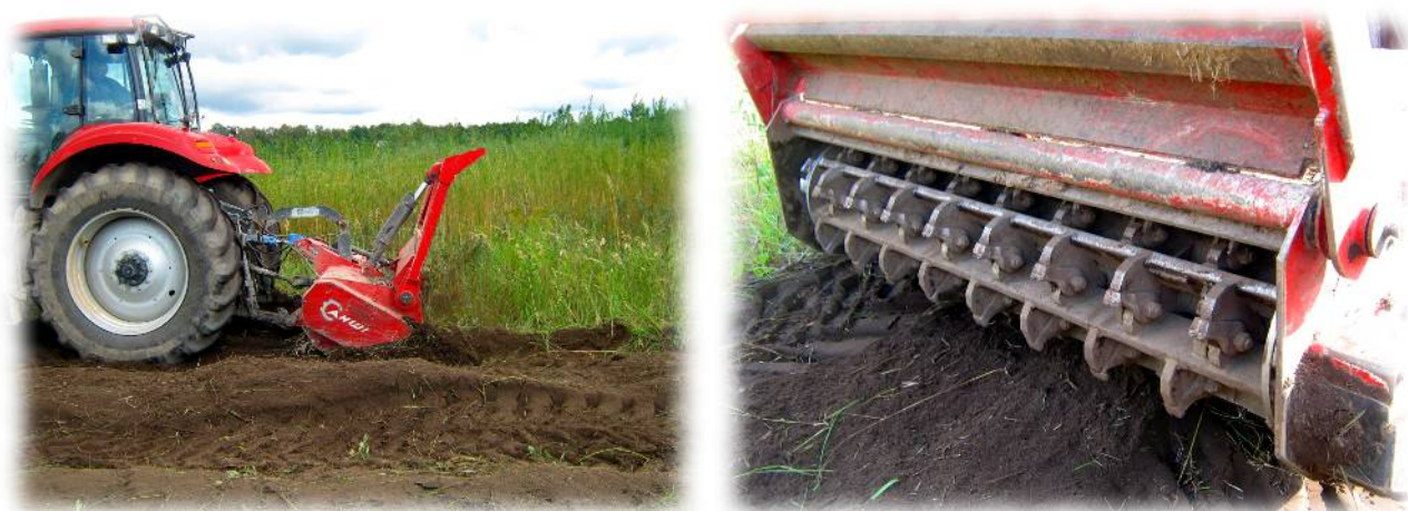
25. Attēls: Platības rekultivācija izmantojot augsnes frēzi.
