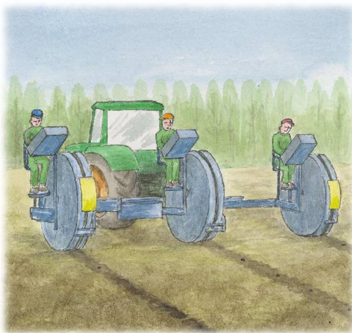
8. Attēls: Īscirtmeta plantāciju ierīkošana ar trīsrindu stādāmo mašīnu.
