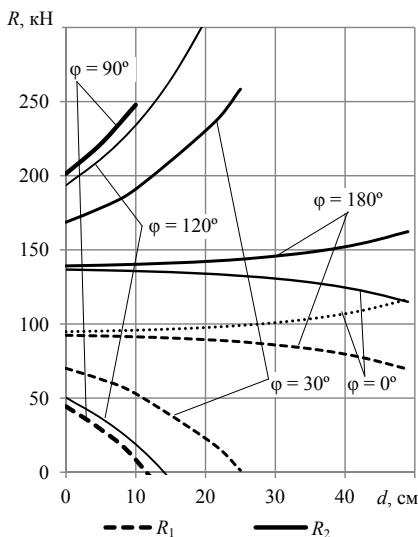
Рис. 7. Влияние диаметра пня ( $d$ ) и угла ( $\phi$ ) между направлением корчевки и опорной поверхностью на распределение опорных реакций корчевателя
