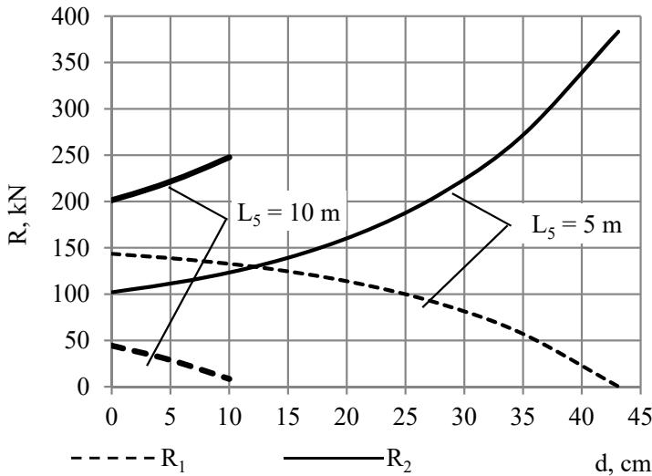
2.3. att. Celma caurmēra (d) un hidromanipulatora ( $L_5$ ) izlices ietekme uz atbalsta kāpurķēžu reakciju
