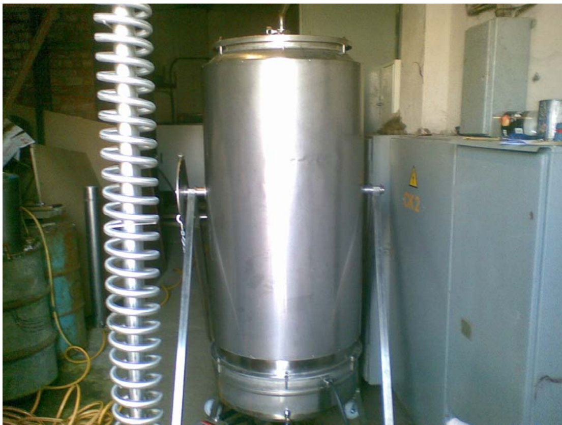
4. attēls. Pilotiekārta augu materiāla ēterisko eļļu iegūšanai.
