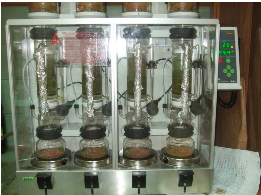
7. attēls. Ekstrakcijas iekārta ekstraktvielu iegūšanai laboratorijā.
