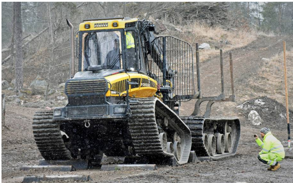
Zviedru eksperti veic galveno tehnisko parametru un funkcionalitātes pārbaudi pilnībā samontētam OnTrack pievedējtraktoram Skogforsk vibrācijas poligonā Zviedrijā.
